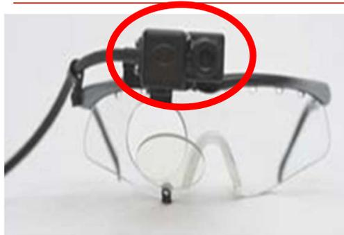
Il Mobile Eye Tracker è una strumentazione progettata per il monitoraggio e il tracciamento dello sguardo dell'occhio:
